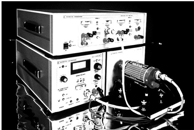
FIGURE 1. SYSTEM IIA POWER SENSOR CALIBRATION SYSTEM
